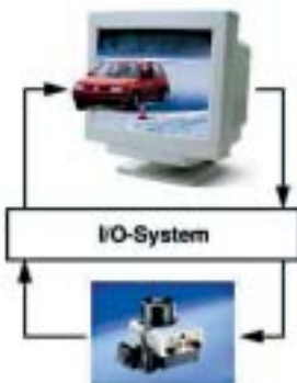
Figura 4.37 Ejemplo de aplicación de ECU en la etapa Hardware in the Loop de su proceso de diseño.
