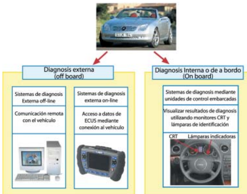
Figura 1.3 Configuración general de un sistema completo de diagnosis electrónica.
