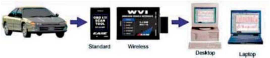
Figura 3.40 Elementos y conexión entre el coche y el equipo de diagnóstico
