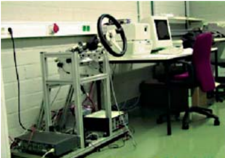
Figura 4.62 Ejemplo de emulador en el ensayo de un sistema Steer-by-wire.
