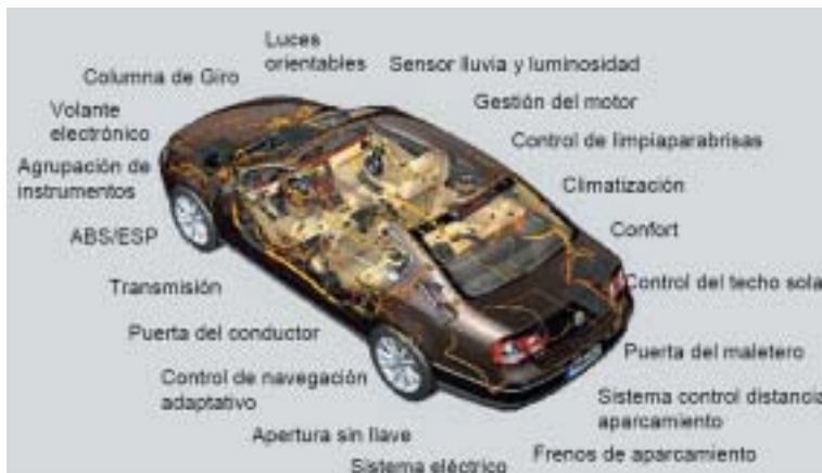
Figura 3.5 Ejemplos de ECUs en un vehículo actual (2005).
