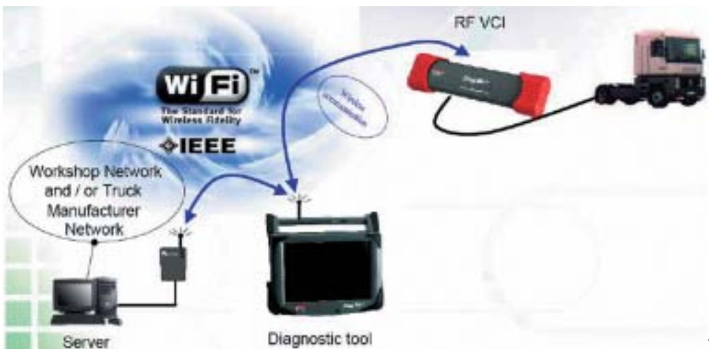
Figura 4.69 Ejemplo de comunicación inalámbrica entre un vehículo, scantool y centro de datos remoto.
