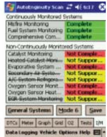
Figura 3.38 Imagen de una PDA dedicada a la diagnosis con un software especializado.
