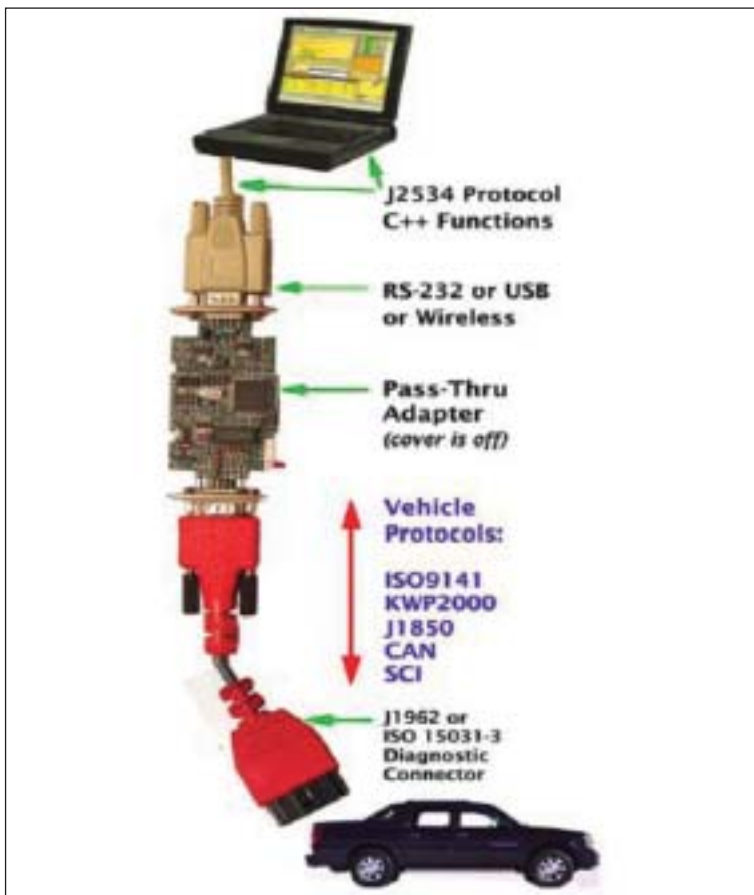
Figura 2.19 Configuración general para la comunicación entre el ordenador central de a bordo y el equipo de diagnóstico externo
