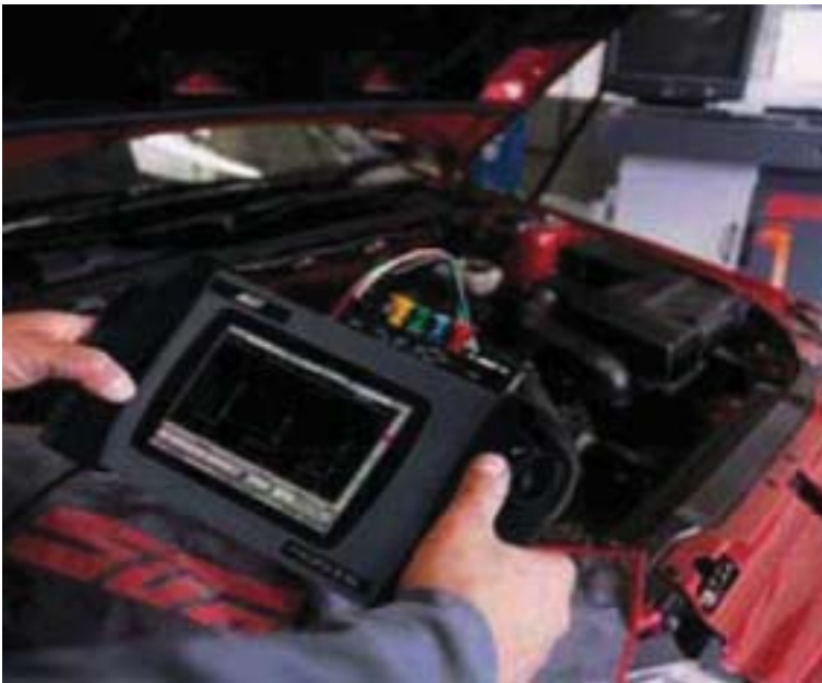
Figura 2.3 Ejemplo de diagnosia externa utilizando Scantool
