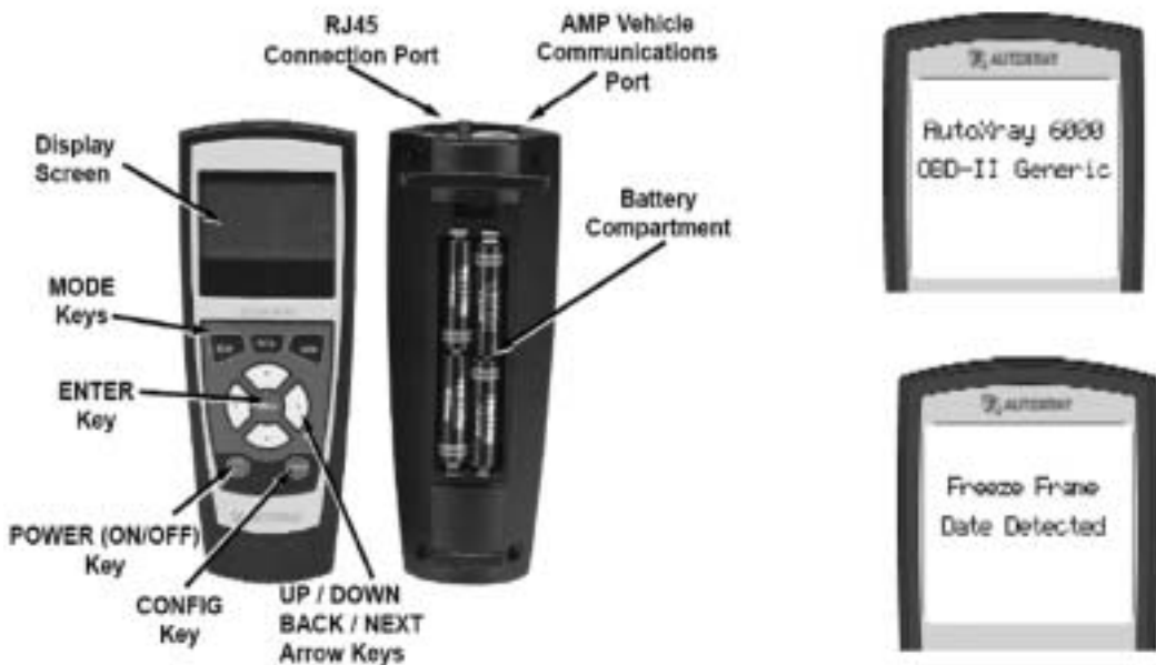
Figura 3.39 Vistas de una scantool junto con alguna de sus pantallas de diagnosis.
