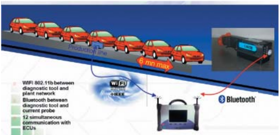
Figura 4.75 Servicios de diagnóstico y calibración en el entorno de una línea de fabricación
