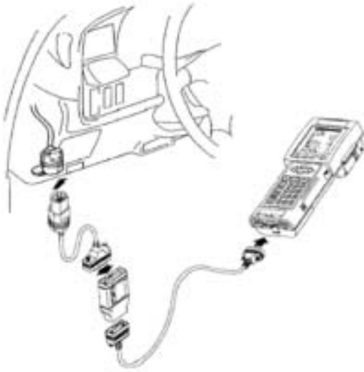
Figura 2.12 Ejemplo de lectura de códigos DTCs utilizando scantool.
