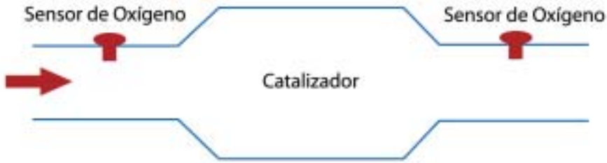
Figura 2.8 Sensores adicionales para la monitorización del catalizador.
